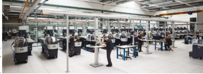
In der neuen Produktionshalle arbeiten bereits 50 CNC-Drehautomaten. Zusätzlich stehen rund 200 m<sup>2</sup> Fläche für weitere Drehmaschinen zur Verfügung
